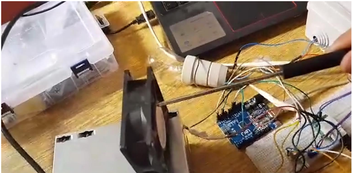
Slika 8. Trenutak kada je vrijednost temperature iznad granice, hlađenje senzora
